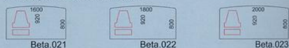
плотове с интегрирана конферентна част по фронта и носеща конструкция - метални крака
